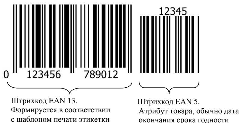
Рис. 6.2 – Структура штрихкода EAN 13+5
