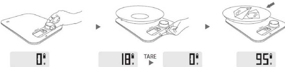
Поставьте на весы емкость, светодиодный дисплей покажет вес емкости.
