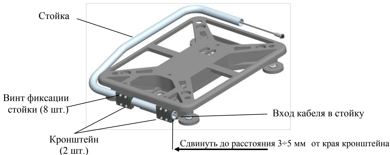
Рисунок 2 – Установка круглой вращающейся стойки
