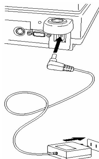
□ Вставьте вилку адаптера в сетевую розетку. Весы проходят самотестирование, при котором на дисплее последовательно высвечиваются сообщения:
