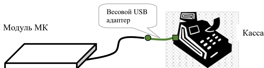
Рис. 6.6 Подключение модуля к кассовому оборудованию.
