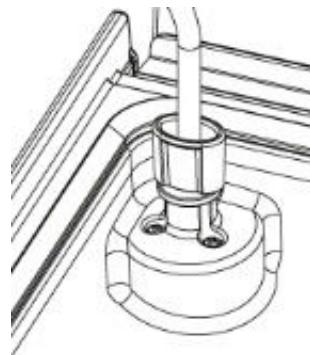
• Rimuovere il filtro dell'aria sopra l'attacco per il tubo flessibile del vuoto e metterci l'adattatore. Mettere nel recipiente per sotto vuoto i cibi. Mettere sopra il coperchio del recipiente e collegare il tubo flessibile del vuoto. Poi con l'adattatore all'attacco collegare alla camera del vuoto dell'apparecchio.
