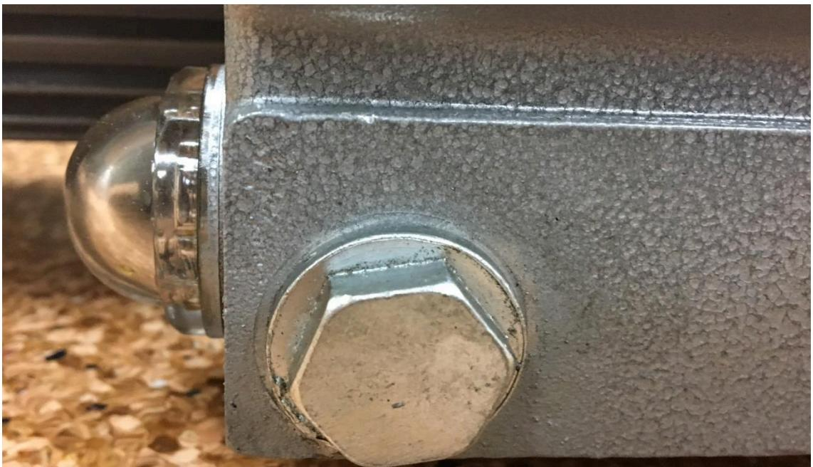
Ждем пока стечет отработанное масло и закручиваем болт обратно. Далее производим заливку масла как описано в процессе ввода в эксплуатацию. При каждой замене масла желательно также осматривать воздушный фильтр, который находится в задней части насоса:
