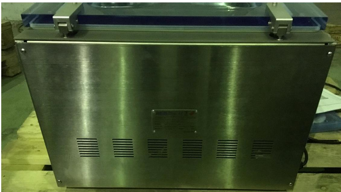
Во всех напольных моделях (однокамерные, двухкамерные, серия 2L) и бескамерных на задней стороне крышка открывается путем отгибаания замков крышки:
