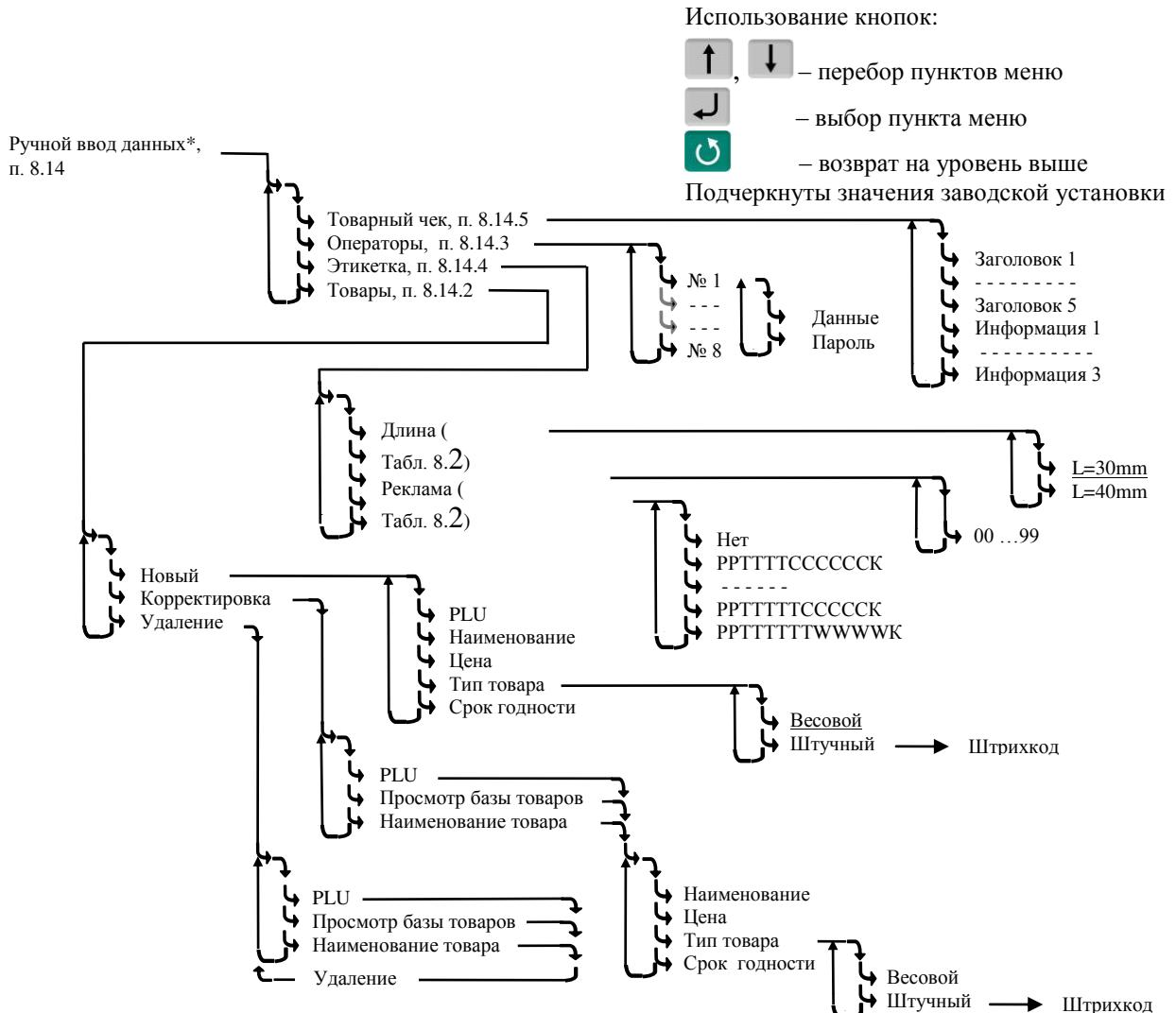
Рис. 8.2 – Схема заполнения справочников с клавиатуры терминала
