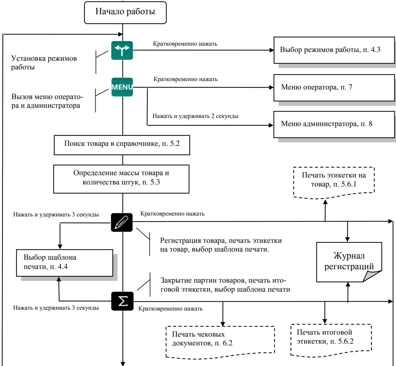
Рис. 3.1 – Схема работы терминала RP (R2P)
