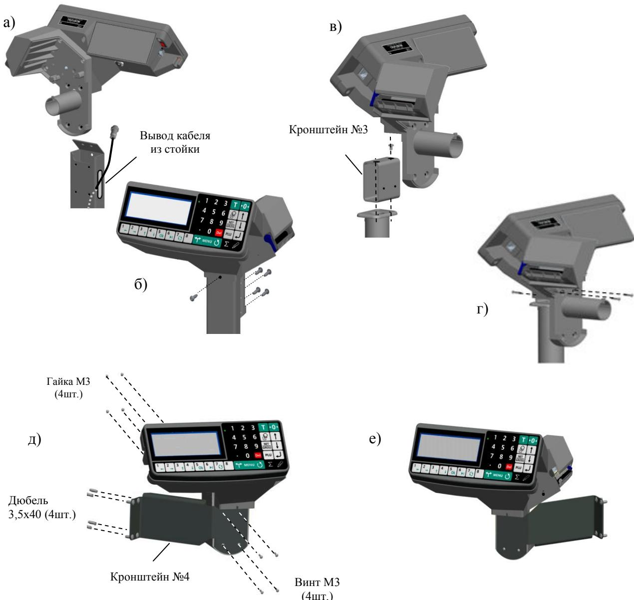
Рис. 2.2 – Варианты крепления терминалов RP и R2P:
