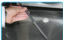
**Sonda di rilevamento temperature al cuore**
