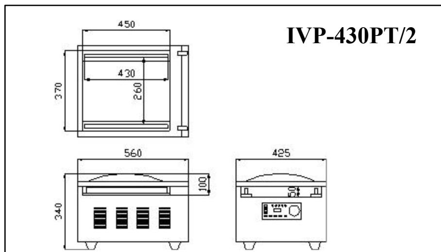
Рисунок 4.8 – Размеры вакуумного упаковщика модели IVP-430PT/2
