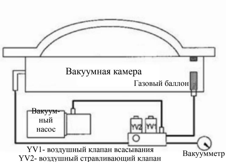
Схема вакуумного упаковщика с производительностью вакуумного насоса 10 м<sup>3</sup>
