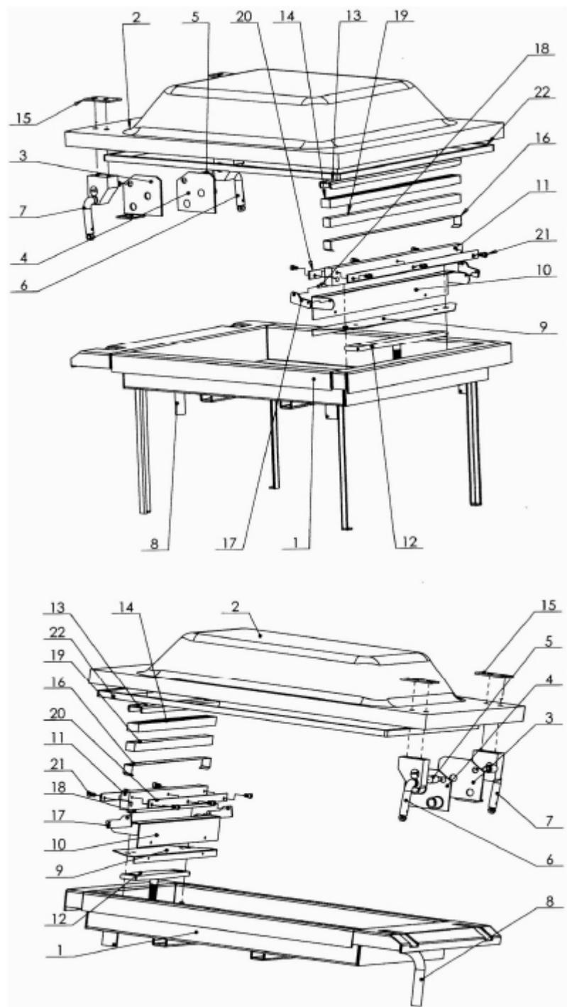
Рисунок 7.1 - Покомпонентное представление модуля вакуумной камеры
