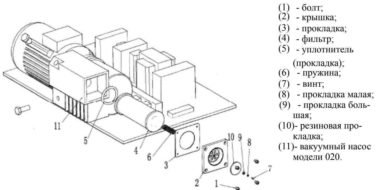
Рисунок 7.5 - Схема элементов вакуумного насоса модели 020
