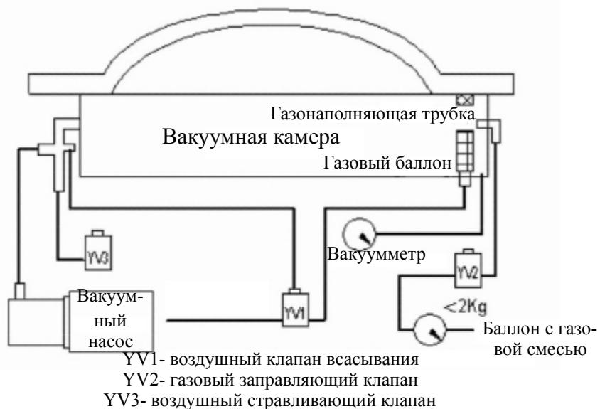
Схема вакуумного упаковщика с системой газации
