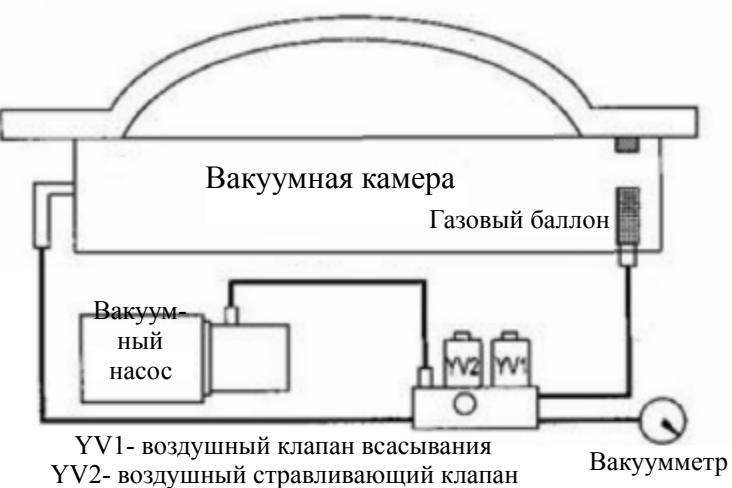
Схема вакуумного упаковщика с производительностью вакуумного насоса более 20 м<sup>3</sup>
