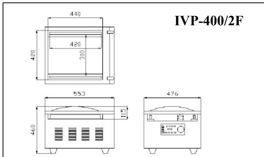
Рисунок 4.6 – Размеры вакуумного упаковщика модели IVP-400/2F
