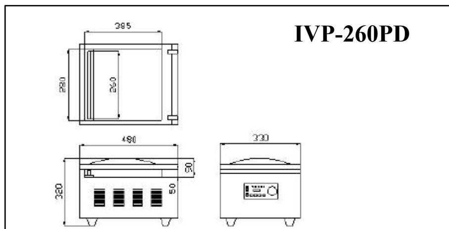
Рисунок 4.7 – Размеры вакуумного упаковщика модели IVP-260PD
