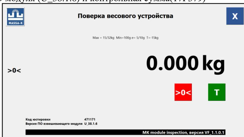
Рисунок 16 – Основной рабочий экран ПО «МАССА-К: ПП «МК module inspection»»
