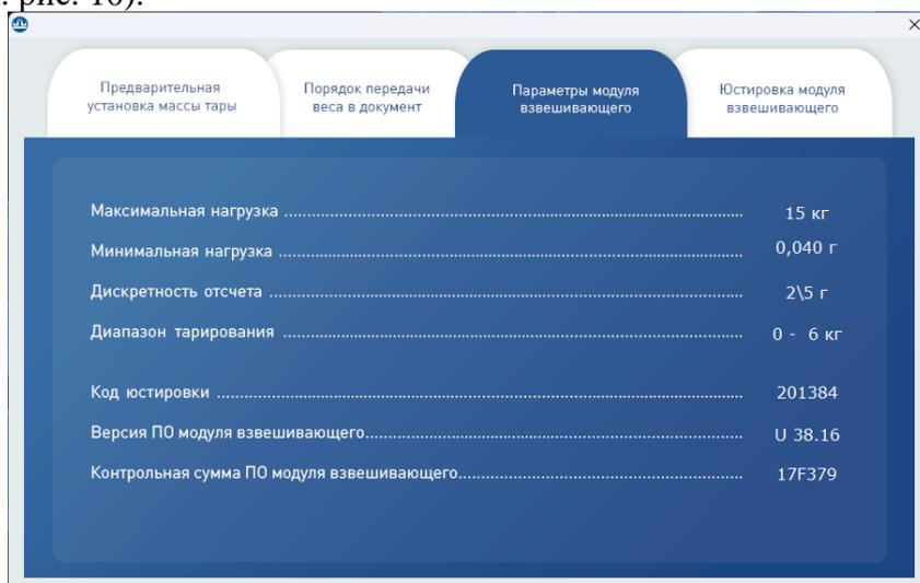
Рисунок 10 – Отображение параметров модуля в ПО «МАССА-К: Весовой терминал 100»
