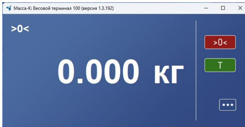
Рисунок 4 – Основной рабочий экран ПО «МАССА-К: Весовой терминал 100»
