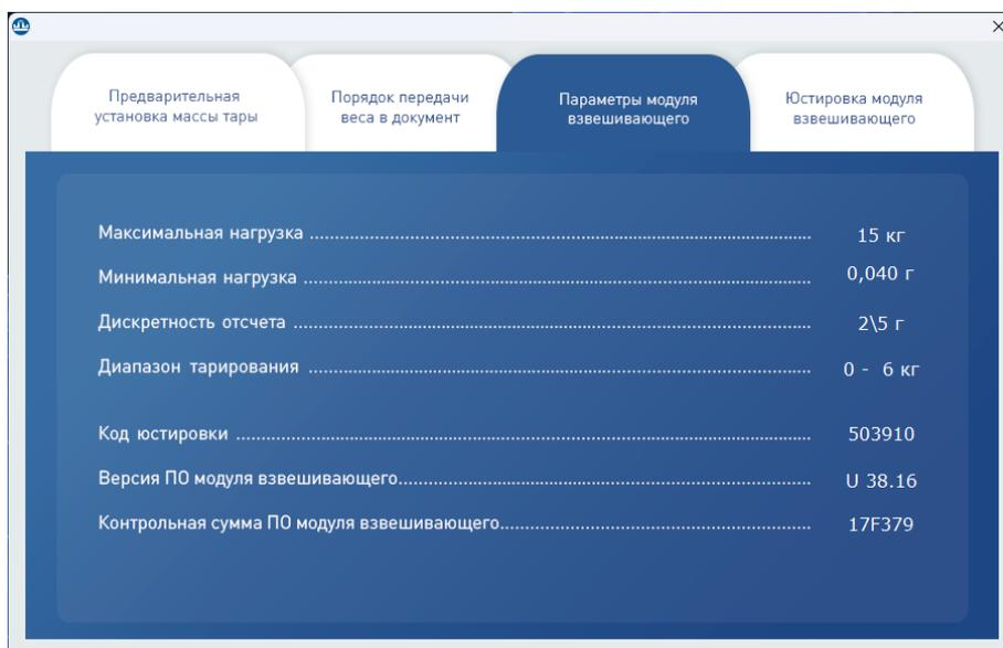
Рисунок 15 – Отображение параметров модуля в ПО «МАССА-К: Весовой терминал 100»
