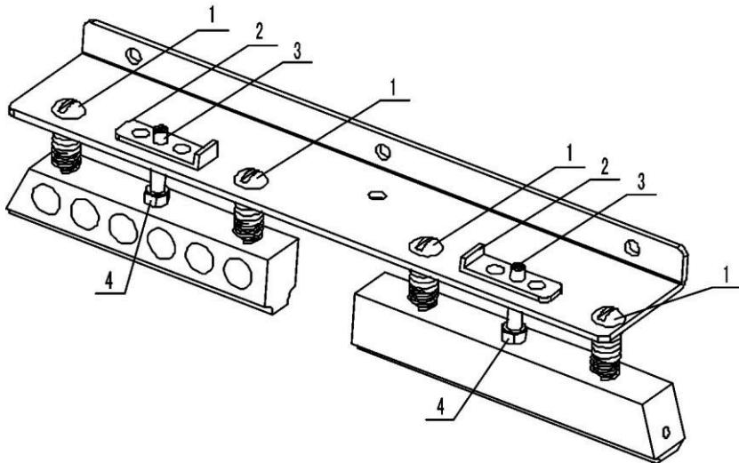
1. винт 2. стопорная планка 3. закрепляющий винт 4.гайка
