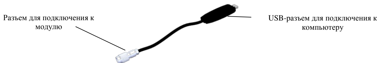
Рисунок 8 – Весовой адаптер USB/МК,ТВ
