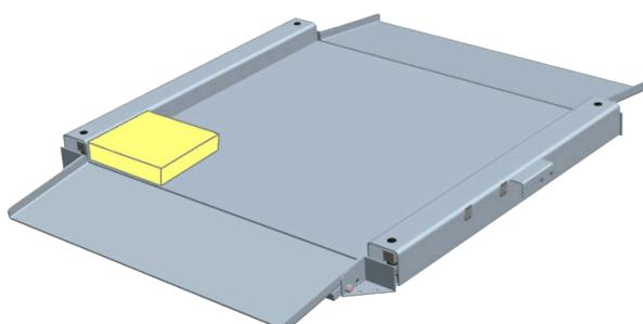
На платформу модулей 4D-LA, 4D-M, перед установкой гирь, подложить деревянный брускок, размером, примерно, 200 x 200 x 50мм. Это позволит установить гири ближе к углу.
