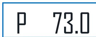
Установить товар на весы. При взвешивании допускается работа с тарой (п. 7.1) и кнопкой ►0►. На индикаторе отображается масса товара в процентах.
