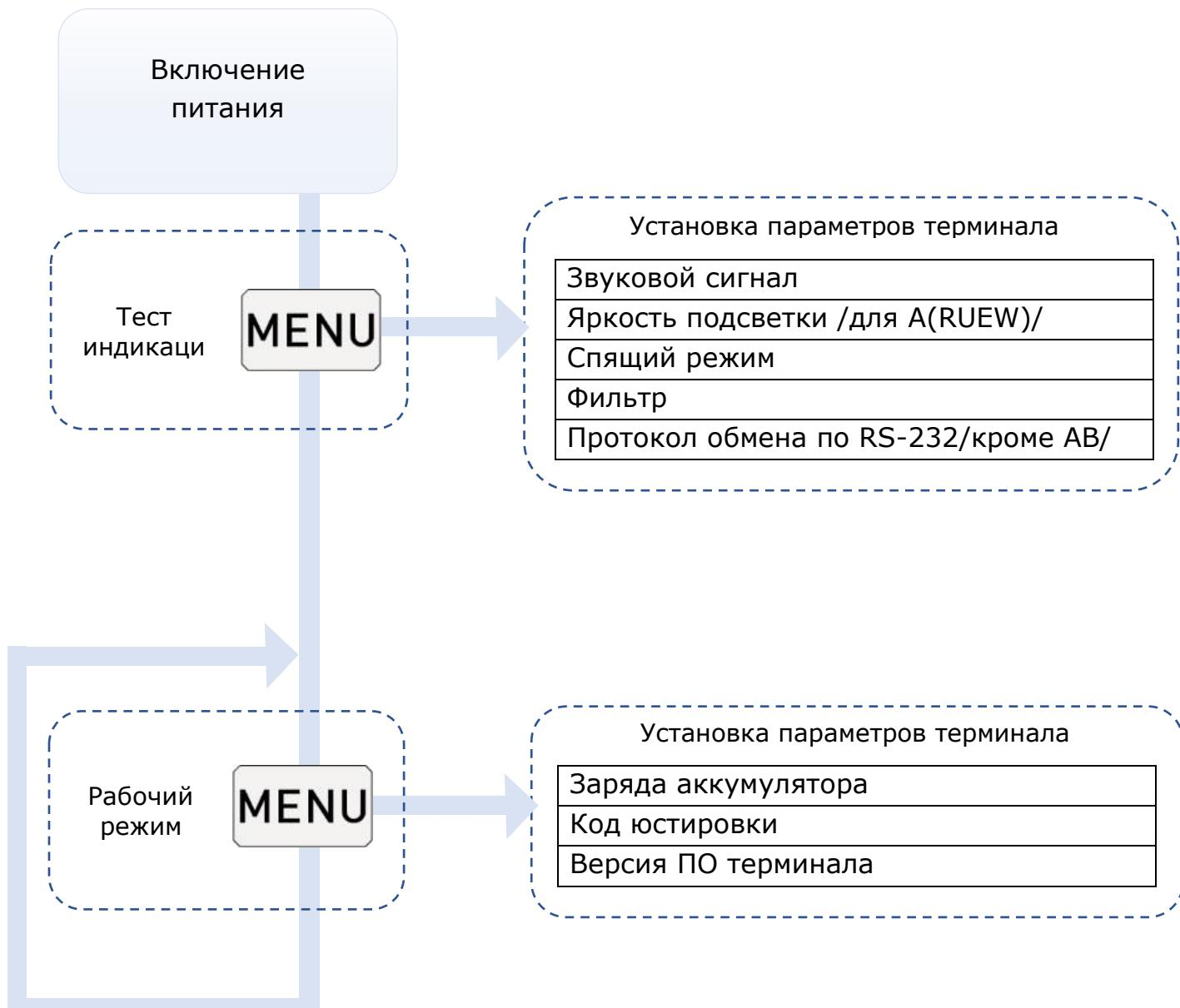
Рисунок 6.1 Порядок установки и контроля параметров терминала
