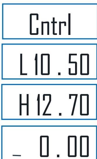
Включить весы и во время прохождения теста нажать и удерживать около 3-х секунд кнопку . На индикаторе последовательно высветится следующая информация: надпись «CntrL», установленные значения минимальной (L) и максимальной (H) массы и 0.00kg с символом «\_». Весы готовы к взвешиванию в режиме контроля массы.
