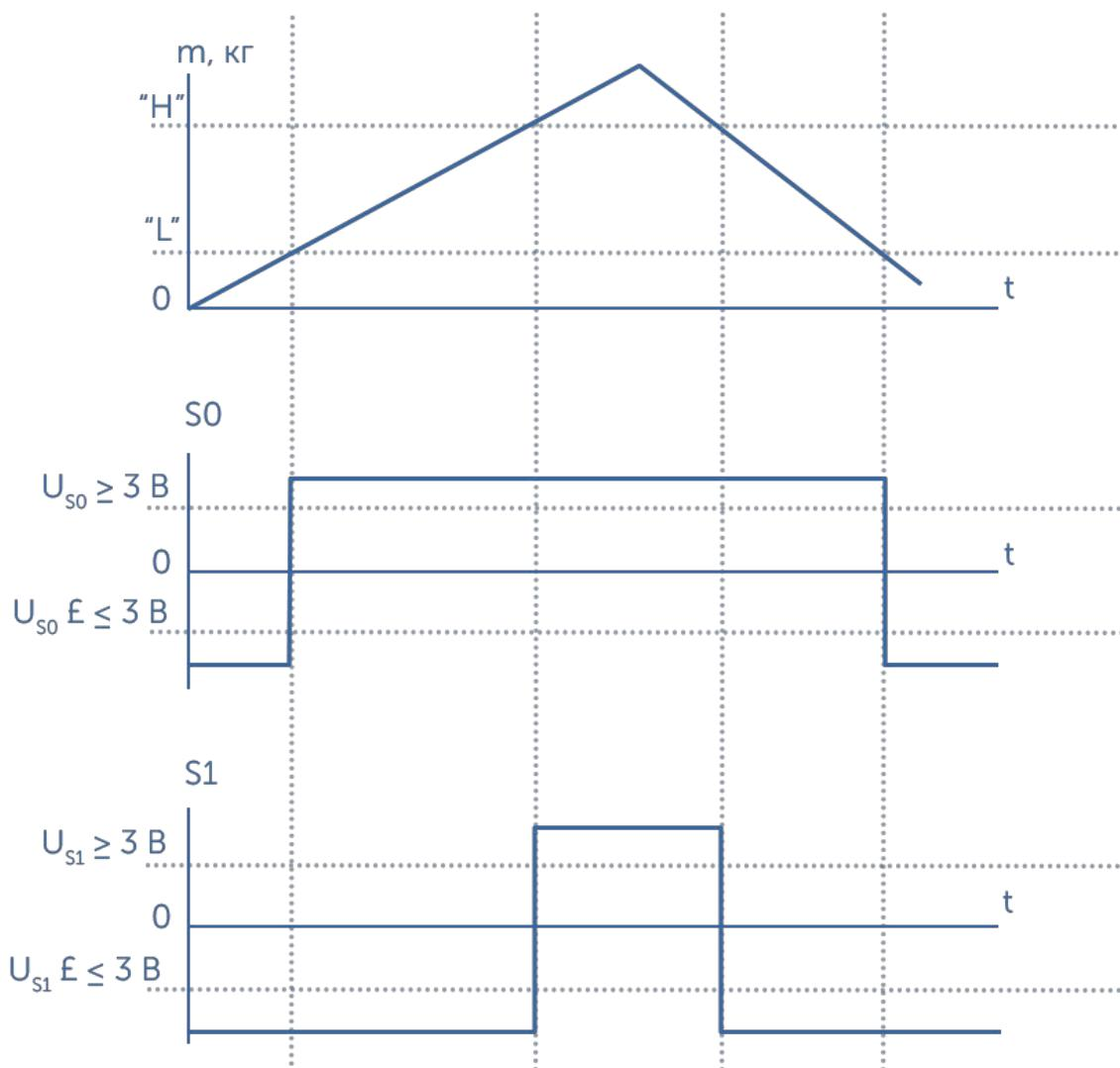
Рис. 8.3. Зависимость сигналов управления от нагрузки на весах
