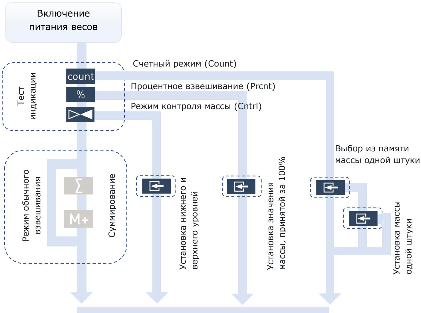
Рисунок 8.1 Порядок установки различных режимов работы терминала.
