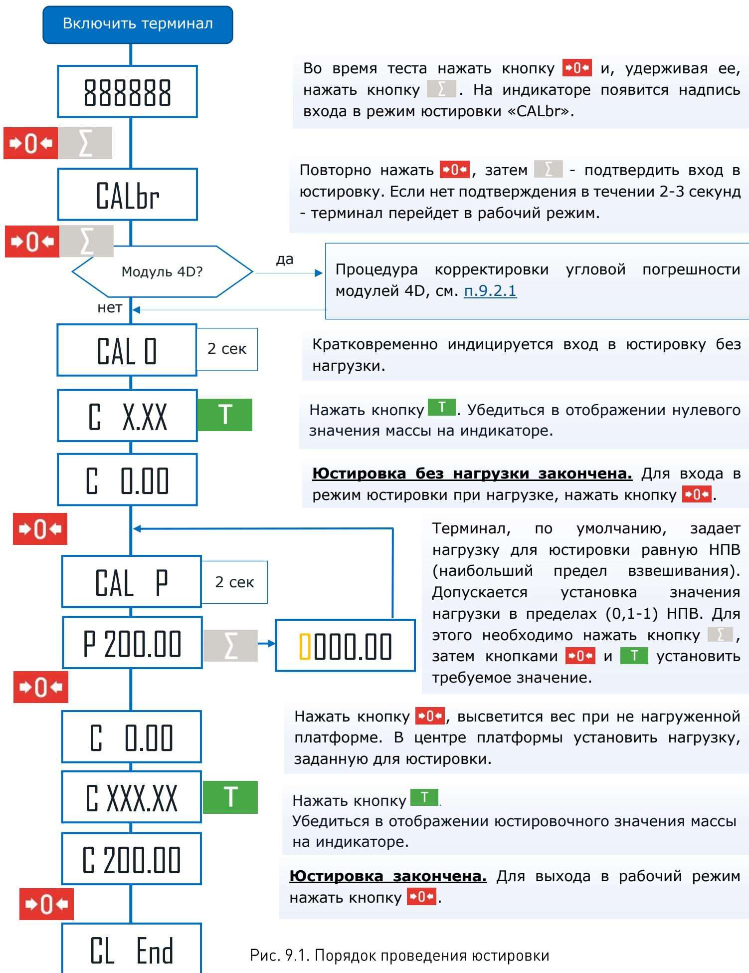
Рис. 9.1. Порядок проведения юстировки
