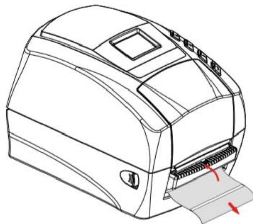
13. Нажмите на кнопку «Feed», чтобы проверить работу отделителя.
