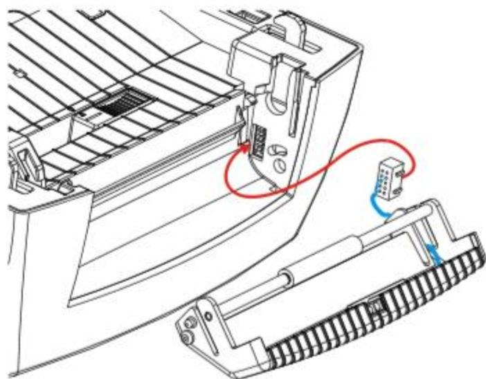
5. Сперва вставьте правую сторону отделителя наклеек в соединительные отверстия принтера (стрелка 1), надавите на нижнюю левую часть отделителя (стрелка 2), затем вставьте левую его сторону в соединительные отверстия принтера, чтобы надежно зафиксировать модуль. (стрелка 3).
