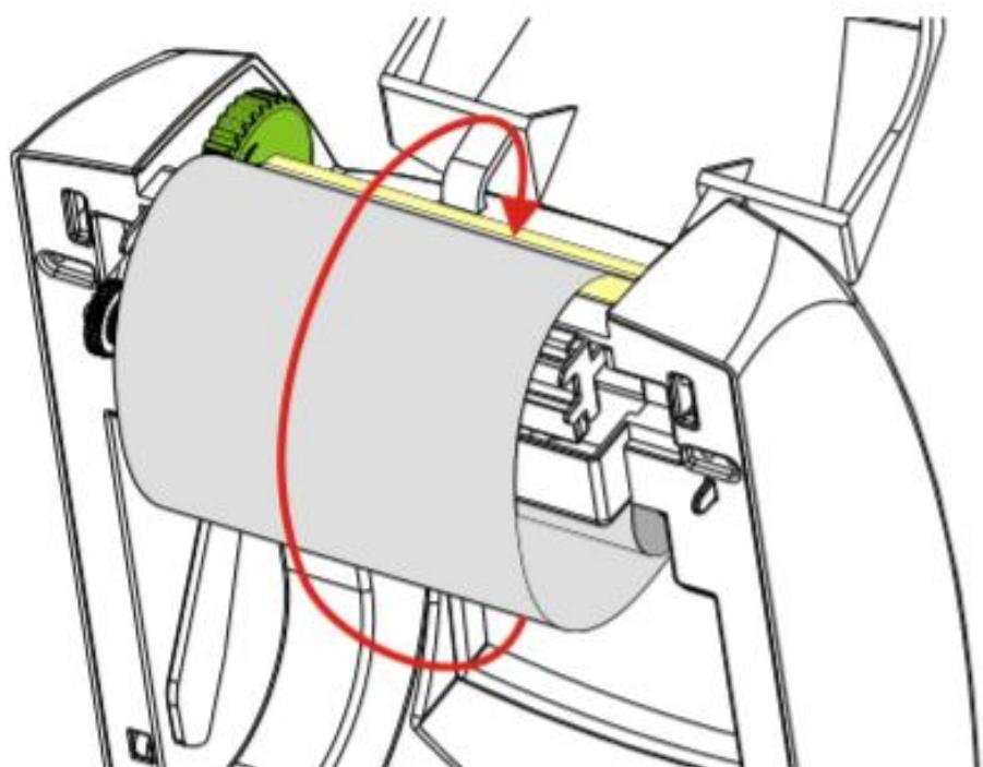
7. Вращая установочное колесо, расположенное слева от ленточной рамки рядом с приемным шпинделем, плотно натяните ленту по всей ширине печатающей головки.
