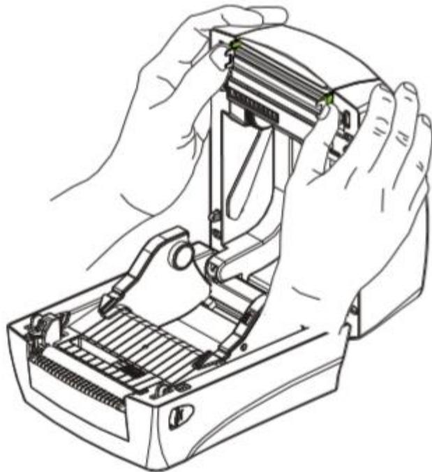
3. Сначала наденьте ленту переноса (рибон) на правый подающий шпиндель. Нажмите на него, **Вдвиньте внутрь правый шпиндель** и наденьте левую сторону рулона ленты на левый шпиндель ленты. Вращайте рулон ленты на левом шпинделе, пока пазы катушки рулона не зафиксируются на шпинделе.
