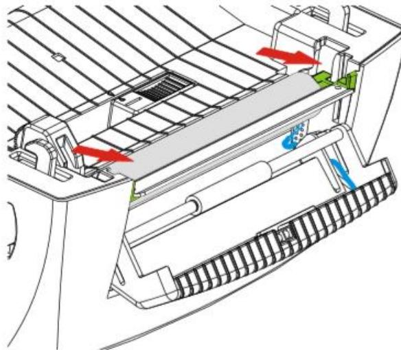
10. Вставьте подложку этикеток между откидной крышкой отделителя и корпусом принтера.
