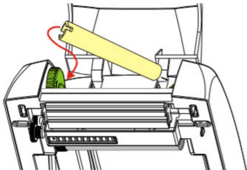
6. Вытяните начальный участок ленты переноса (рибона) из-под ленточной рамки и оберните его вокруг рамки. Имеющейся на нем полоской липкой ленты прикрепите его к пустой катушке на принимающем **нодаюнцем** шпинделе. Лента переноса (рибон) должна располагаться по центру катушки.
