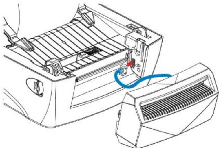
5. Опустите резак по направляющим так, чтобы фиксирующие крючки резака попали в пазы принтера.
