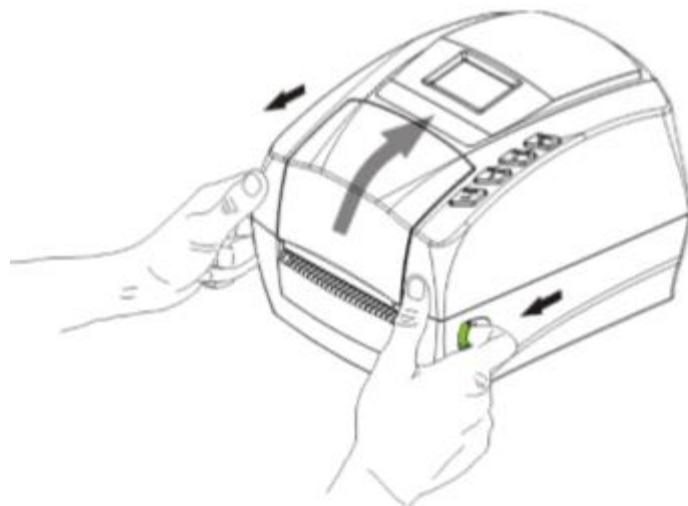
2. Для откидывания крышки, прикрывающей ленту переноса, нажмите на боковые рёбра, как это показано на картинке. (ребра выделены зеленым). Не откидывайте крышку нажатием на самый край панели там, где установлено лезвие для отрыва этикеток, т.к. Вы можете пораниться.
