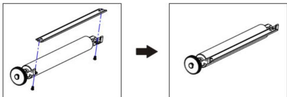
7. Вставьте валик с металлической пластиной в принтер.
