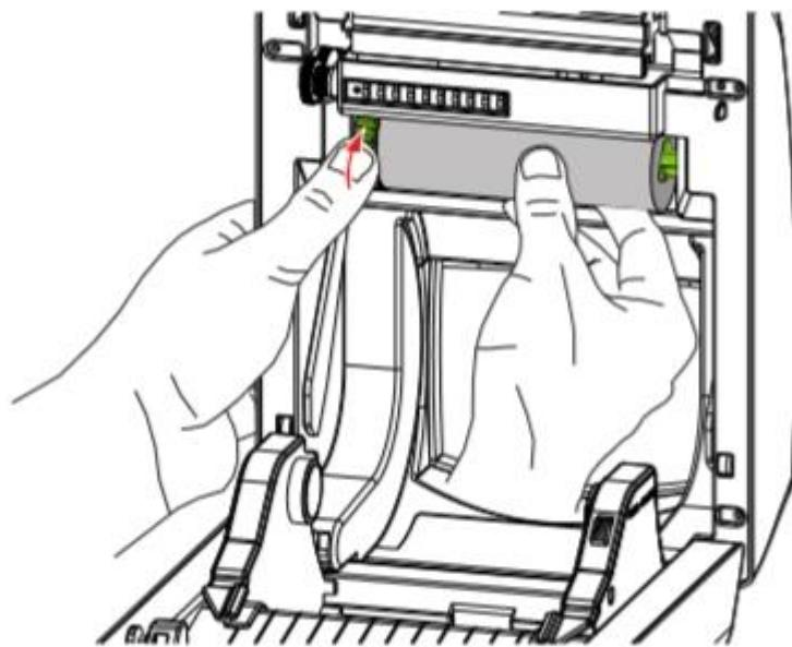
5. Вставьте пустую катушку ленты в приемный шпиндель. Поворачивайте катушку, пока он не совпадет с пазом, и зафиксируйте с левой стороны приемной втулки.
