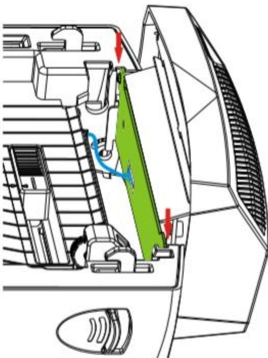
6. Нажмите на фиксаторы резака так, чтобы нижние крючки надежно сели в пазы принтера.
