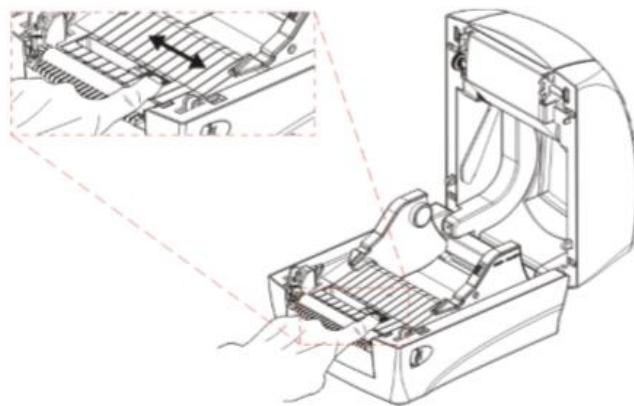
5. Потяните носитель так, чтобы он выступал за пределы передней части принтера и заправьте носитель под направляющие для бумаги с обеих сторон.
